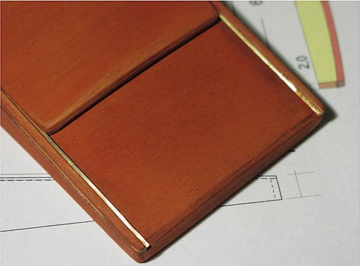
Forma ad arco di cerchio (42cm) per assemblare 4 strati di impiallicciatura di legno di pero per avere un sandwich ricurvo per costruire il tetto scorrevole su guide in ottone.
